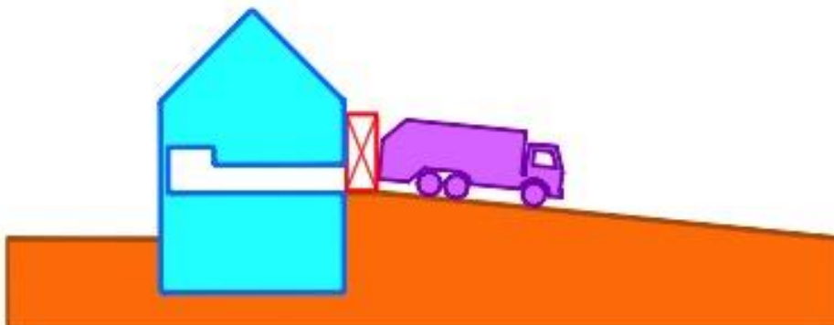
Situatie met containerruimte boven maaiveld
