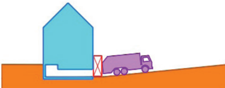
Situatie met containerruimte onder maaiveld
